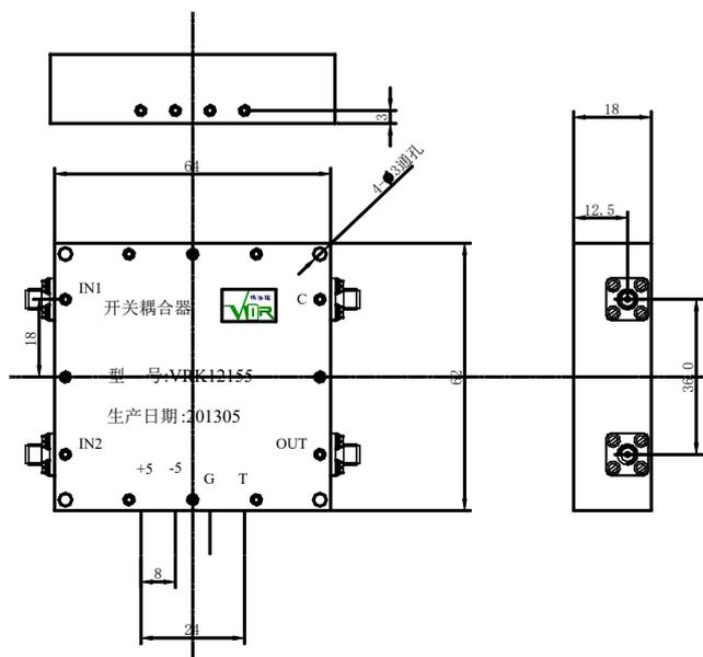
图例 2 开关耦合器
